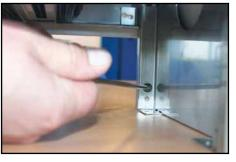
2. Ослабьте фиксирующие винты с головкой под шестигранный торцевой ключ и снимите кожух
