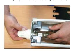
**14.** Закрепите кожух фиксирующими винтами
