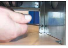
2. Ослабьте фиксирующие винты с головкой под шестигранный торцевой ключ и снимите кожух
