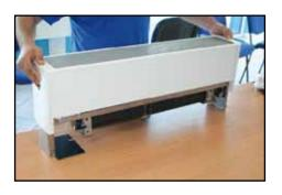
**13.** Закрепите кожух фиксирующими винтами
