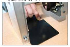
**9.** Подключите угловой клапан к выходу оборотной воды
