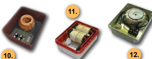
Трансформатор ТТ-100 в электромонтажной коробке (размер коробки: 175x70x145мм), мощность 100 ВА Трансформатор ТТ-240 в электромонтажной коробке (размер коробки: 210x70x165мм), мощность 240 ВА Трансформатор ТТ-300 в электромонтажной коробке (размер коробки: 255x71x205мм), мощность 300 ВА
