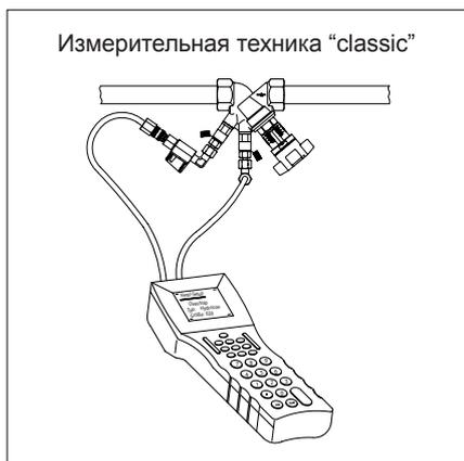
Регулирование расхода с помощью замера перепада давления на измерительной диафрагме.
