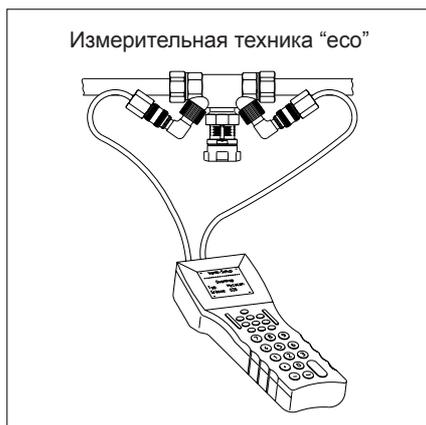
Регулирование с помощью метода равного давления и метода коэффициента  $k_v$
