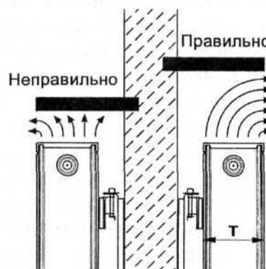
Рис. 6.3. Схемы установки панельного радиатора под
