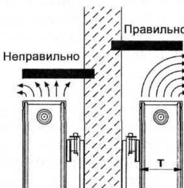
Рис. 6.3. Схемы установки панельного радиатора под
