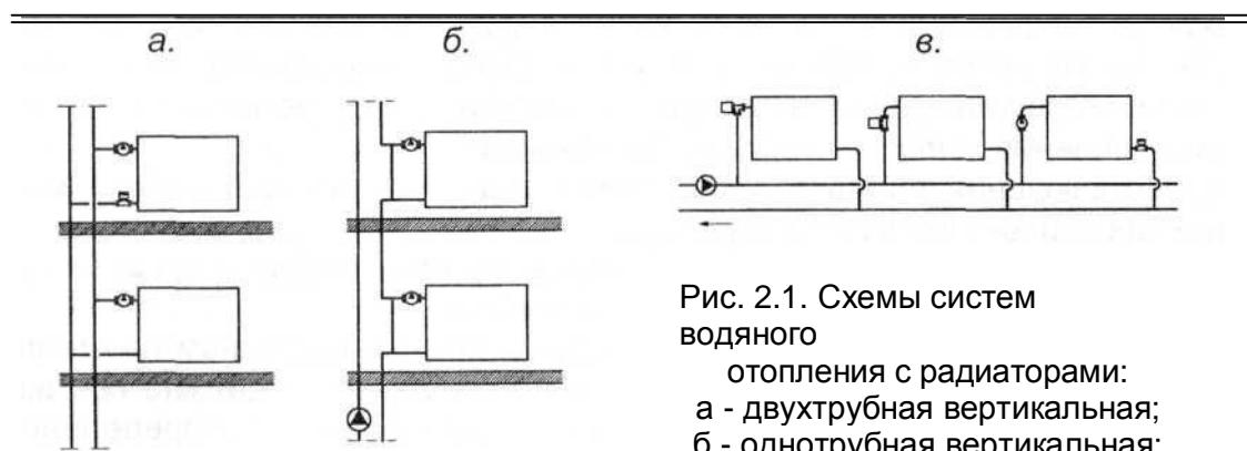
Рис. 2.1. Схемы систем водяного отопления с радиаторами:
