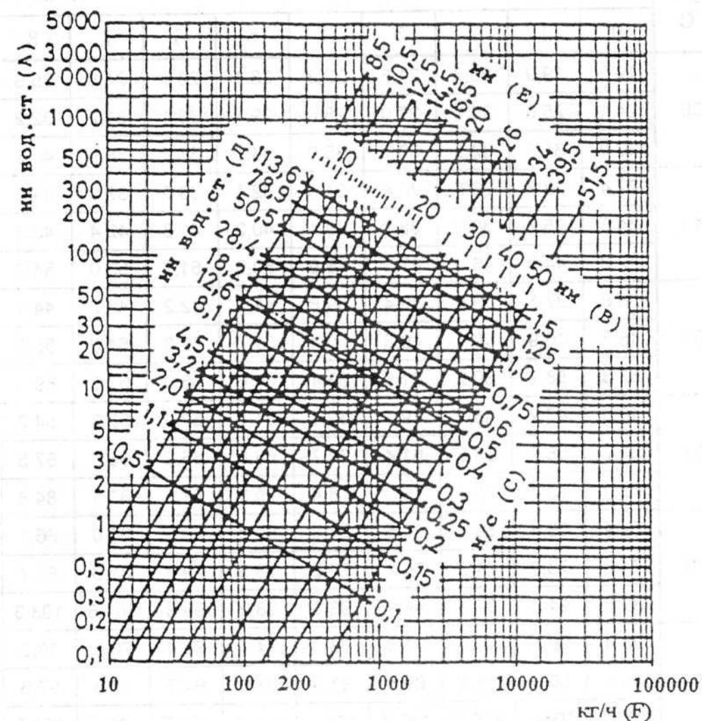
А - потери давления на трение в медных трубах 1 м при температуре теплоносителя 40°C, мм вод. ст.; В - внутренние диаметры медных труб, мм; С - скорость воды в трубах, м/с;
