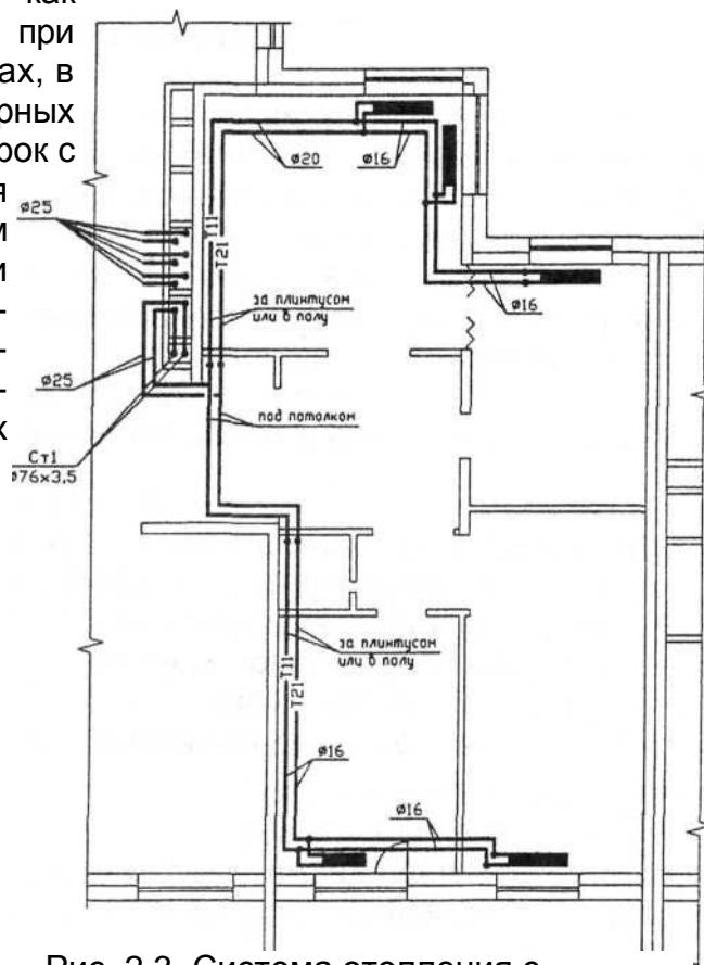
Рис. 2.3. Система отопления с плинтусной разводкой
