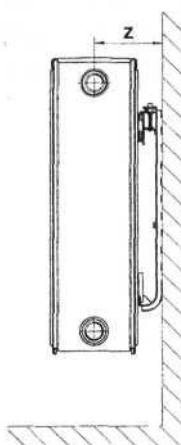
Рис. 6.2. Установка радиатора «VONOVA Kompakt» на стене на кронштейнах-консолях «Vonomat»
