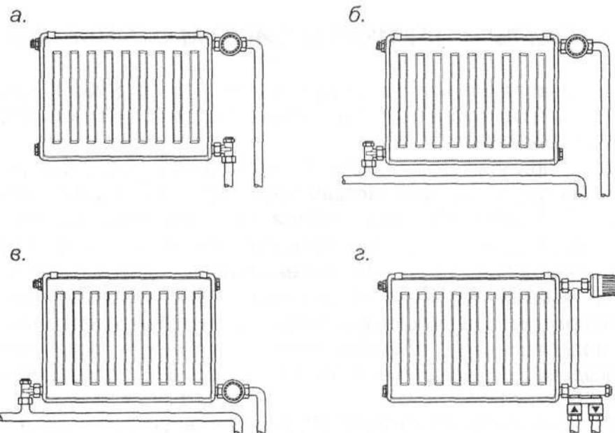
Рис. 2.2. Варианты присоединения радиаторов «VONOVA Компакт» с терmostатами при напольной или плинтусной разводке теплопроводов
