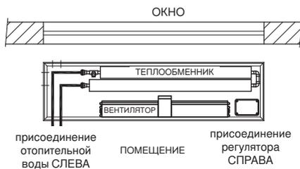
**Б** Теплообменник размещен за пределами охлаждаемой поверхности, вентилятор всасывает воздух прямо из охлаждаемой поверхности.
