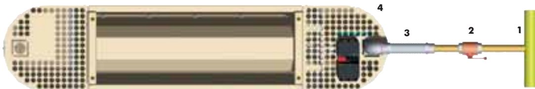
Рис. 21 Схема подключения излучателя SUNRAD к газовой сети
