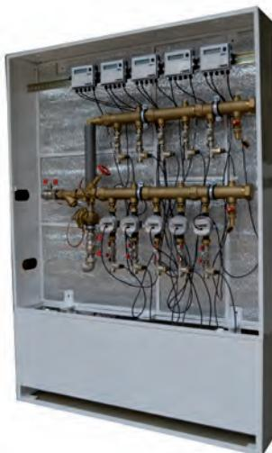
Поэтажный модуль HERZ поквартирного распределения теплоносителя с приборами учета тепловой энергии. Применяется для создания поэтажной системы отопления с высокоеффективной балансировкой и поквартирного учета тепла. Модуль размещен в шкафу или на монтажной раме.
